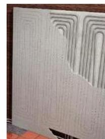
Nei servizi igienici verrà installato un sistema radiante a parete, posizionati sopra i sanitari. Tale sistema è composto da pannelli in gesso rivestito al cui interno è annegata una tubazione collegata al collettore di distribuzione dell' impianto radiante. Questo sistema garantisce l' ulteriore apporto termico richiesto nei locali adibiti a servizi igienici.
